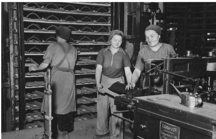
Die von der Familie Spanholtz zur Verfügung gestellten Fotos, von denen hier nur ein kleiner Teil abgebildet ist, zeigen Betriebsabläufe in den 1950er Jahren. Hier sieht man Mitarbeiterinnen am automatischen Dachziegel-Abschneider im Werk I.
